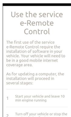
⑥ Démarrez le véhicule et laissez-le tourner pendant environ dix minutes pour l'installation. Arrêtez le véhicule pendant environ deux minutes. Répétez cette procédure pour réaliser les éventuelles mises à jour.
