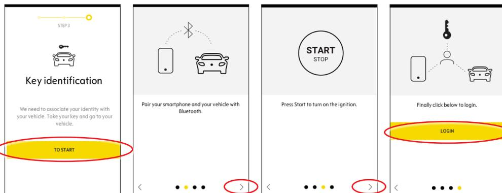
③ Avete identificato con successo la chiave del veicolo. Il vostro smartphone è ora collegato al veicolo. Date un colpo su continua per iniziare a scaricare i dati necessari perché il servizio funzioni correttamente.
