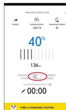
3 ... potete programmare un'ora d'inizio della ricarica per caricare la batteria ad alta tensione.
